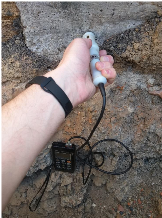
Рис. 3.7.19. Проведение исследования по определению прочностных характеристик бетона фундаментов неразрушающим методом (с помощью прибора «ОНИКС-2.5»)
