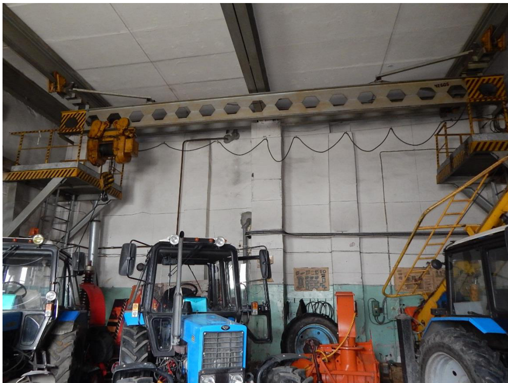
Рис. 3.8.1. Внешний вид кран-балки
