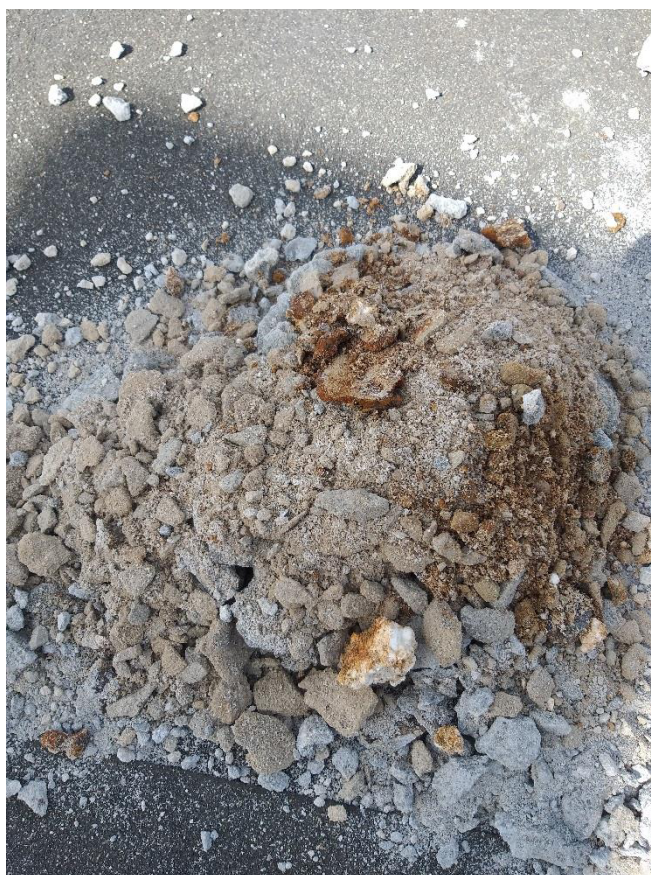
Рис. 3.3.8. Нижний слой стяжки имеет желтоватый цвет, что свидетельствует о избыточном количестве песка в ее составе; разрушается при действии незначительных нагрузок, при разрушении быстро переходит в сыпучее состояние
